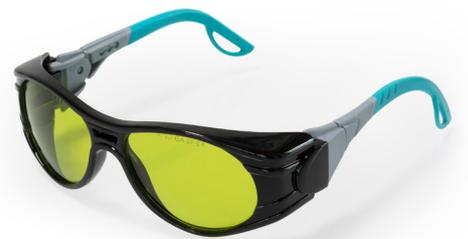
Sperrt Wellenlängen kleiner als 400nm und größer als 900nm. Bei 850nm beträgt die Transmission lediglich 1,7%. Ideal als Schutzbrille, wenn mit UV- und/oder Infrarotlichtquellen gearbeitet wird.
